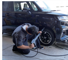
「SBM-500」の貼付を行う前にフェンダー周辺の清掃を行う。泥などの汚れは大敵。フェンダーライナーの表面部をキレイにしておく。
