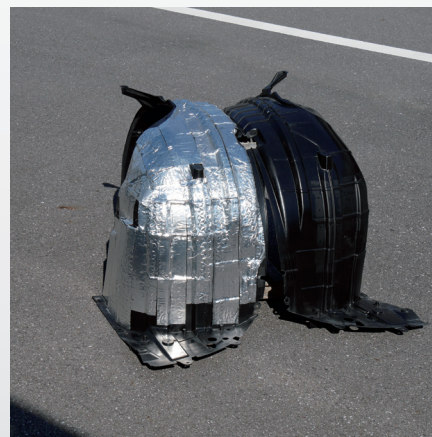
左側が施工後のインナーフェンダーでこのように隙間なくSBM-500を貼り付けることで制振、防音効果が得られます。
