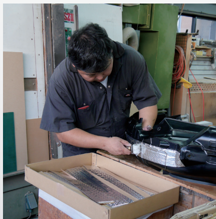
切り出したSBM-500をインナーフェンダーに貼り付けていきます。
