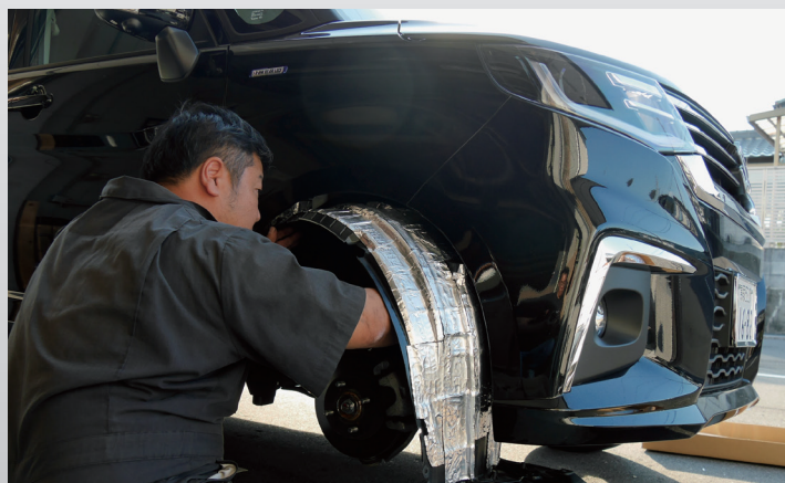
タイヤハウスの施工が済んだらフェンダーライナーをセットアップして完成。
