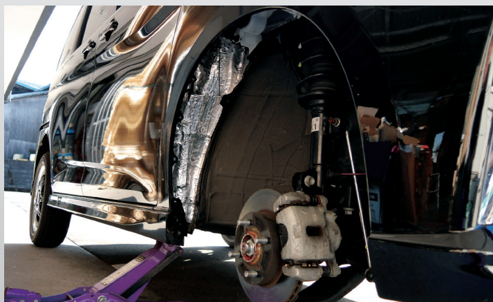
フェンダーライナーと同じく、車両側のタイヤハウス(鉄板などの金属部)に切り出したダンピングコントロールマットをしっかりと貼付する。
