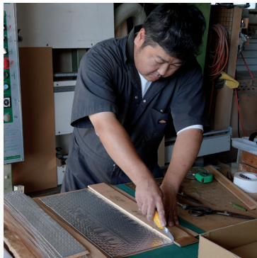
SBM-500を適切なサイズに切り出し。幅は約75mm程度に。表面はアルミ製でベースは高比重のブチルゴムを採用。
