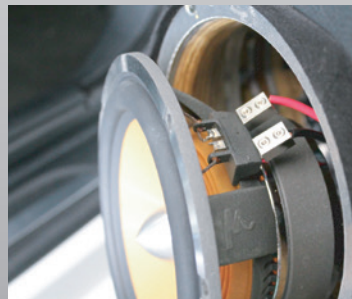
SDJ-02は、ミッドレンジなどの平端子部に使用します。
