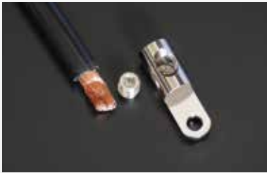
4ゲージ電源ケーブルをターミナルから外した時の導体画像である。導体全体が均一に圧着された理想的な導体。
