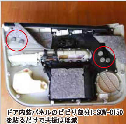
ドアアウターパネルの補強やサービスホールに橋を架けるようにインストール
