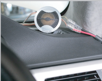
SDJ-01は、ツイーター本体から直接出ているスピーカー線やスピーカー線同士をつなぐ場合に使用します。また、デッキ電源部などの接続にもお勧めです。
