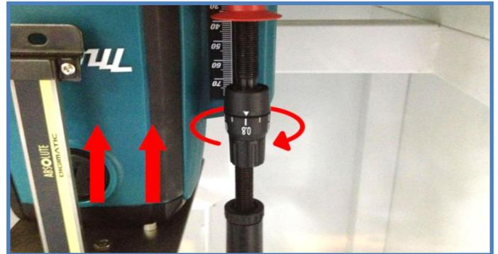
16mmになれば高さ調整用ネジをロックさせます。
