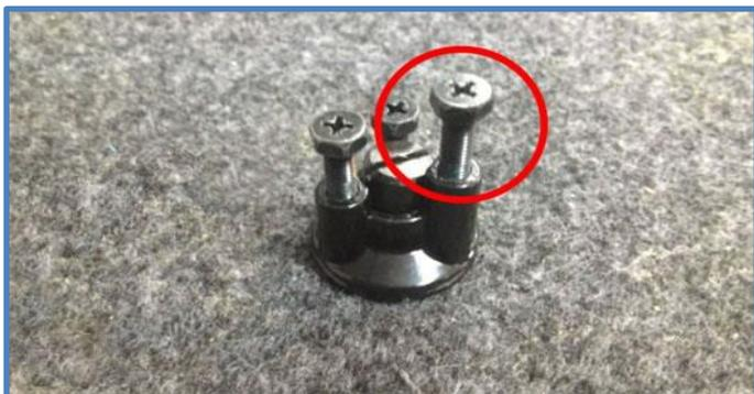
一度、レバーを外し、丸印の一番高い部分のネジを外します。
