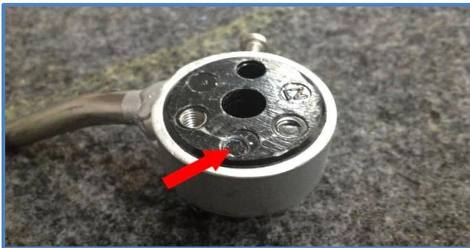
先ほど外したネジに同サイズのナットを付け、ネジロック
