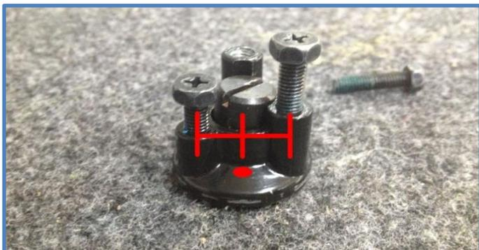
一番低いネジと中間の高さのネジの間に4mmもしくは4.5mmのキリで穴を開けます。(中心の位置)
