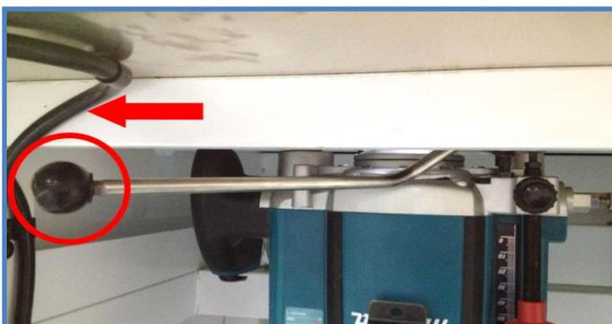
丸印のレバーを左側に動かし、フットペダルを踏みます
