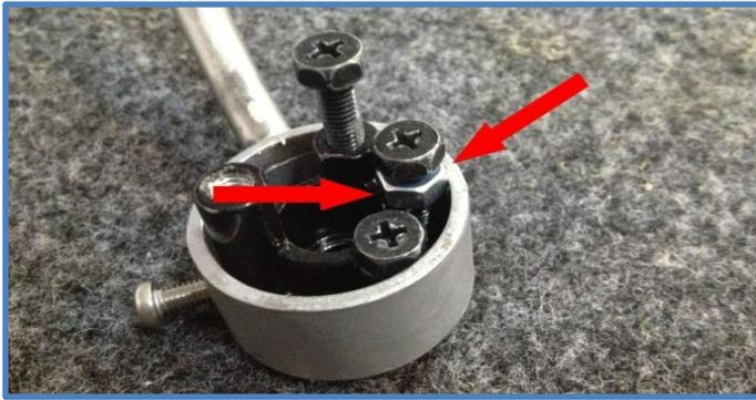
ナットを付けることによって、ナットが矢印左部分の所に乗り、レバーの輪の部分(矢印右)に引っかかるので、ネジをしっかり固定できるのと緩み防止にもなります。
